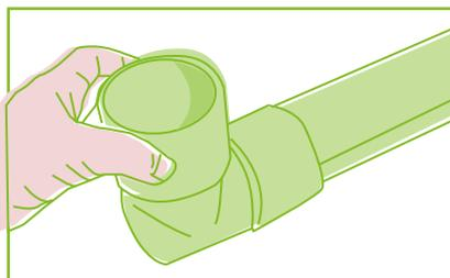
**Tuberías.** Monta el sistema de desagüe y comprueba que funciona. Si es necesario añade tubería de PVC.
