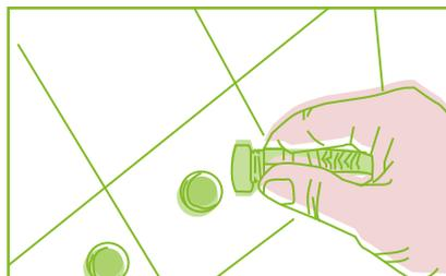
**Conecta latiguillos.** Aprovecha las tomas de agua y coloca los latiguillos de la grifería/columna de ducha.
