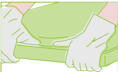
**Presenta y nivela.** Comprueba la medida del plato y ajusta la altura según la tubería. Marca las dimensiones.
