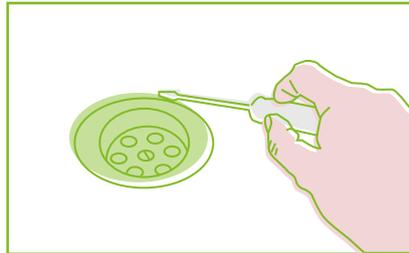
**Válvula de desagüe.** Destornilla y retira la válvula. Empuja el rebosadero y el orificio quedará hueco.
