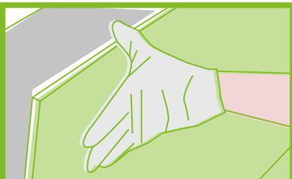
**Laterales.** Según la altura del plato colocar faldón frontal y cubrir laterales con paneles, fijándolos con cola.
