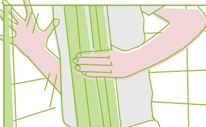
**Coloca la mampara.** Instala las hojas de la mampara y ajusta su colocación con los tornillos de ajuste.
